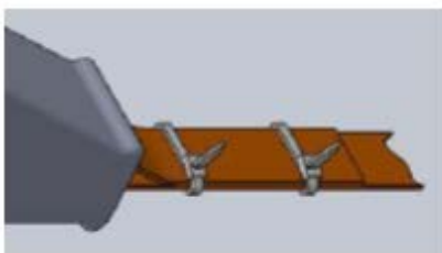
Obr. 2 – detail ukončení a upevnění řemene
