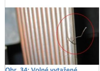
Obr. 34: Volné vytažené tažné vlákno
