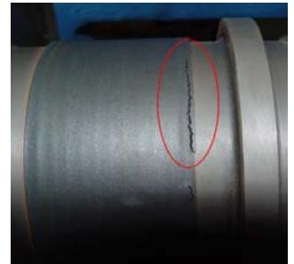
Obr. 35: Podélné trhliny v rubové ploše [ContiTech]
