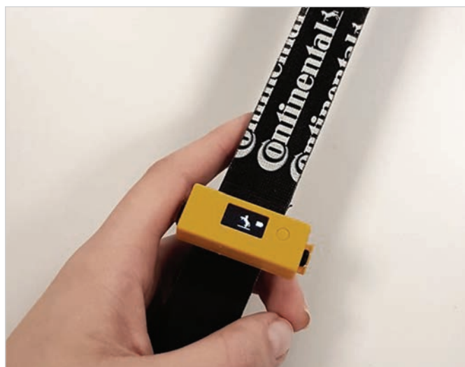
Měřicí přístroj pro měření předpětí řemenů Conti VSM-Mini. (Zdroj: Continental ContiTech PTG)
