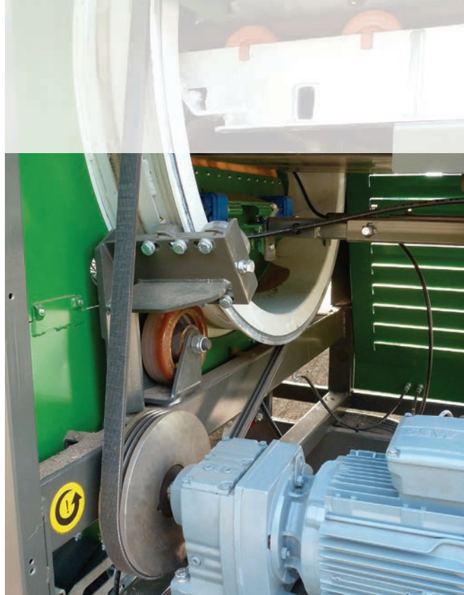
Pohon bubnového rotačního třídíče Zemmler MS1000 drážkovým řemenem Conti Multirib. (Zdroj: Continental ContiTech PTG)
