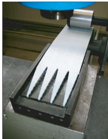
Detail vyseknutého spoje, který je připraven pro svařování.
