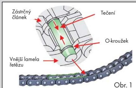
Díky mimořádně dobrým vlastnostem tečení, proniká směs účinných látek a rozpouštědel i do těch nejužších tolerancí čímž zajišťuje optimální ochranu před mechanickým opotrebením. Na povrchu se utváří vysoce účinná, vůči odstředivým silám odolná, vrstva suchého maziva s PTFE. O- a X-kroužky jsou ošetřeny a zůstávají elastické.
