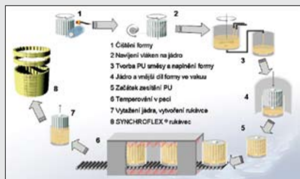
Obr. 1: Způsob výroby ozubeného rukávce
