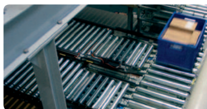
Příklad válečkového dopravníku třídění záslek poháněného drážkovými řemeny
