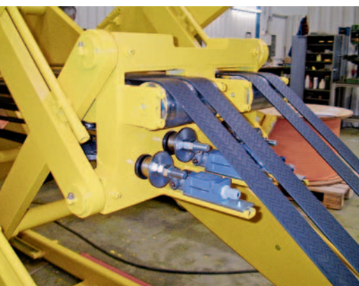
Náhrada hydrauliky plochým řemenem CONTI POLYFLAT® u zvedacího zařízení
