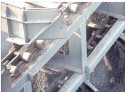
Dopravní řetěz shrnovače s kapacitou 1000 t/hod.
