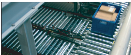
Příklad válečkového dopravníku třídění zásilek poháněného drážkovými řemeny
