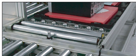
Příklad válečkového dopravníku při výrobě PC poháněného drážkovými řemeny
